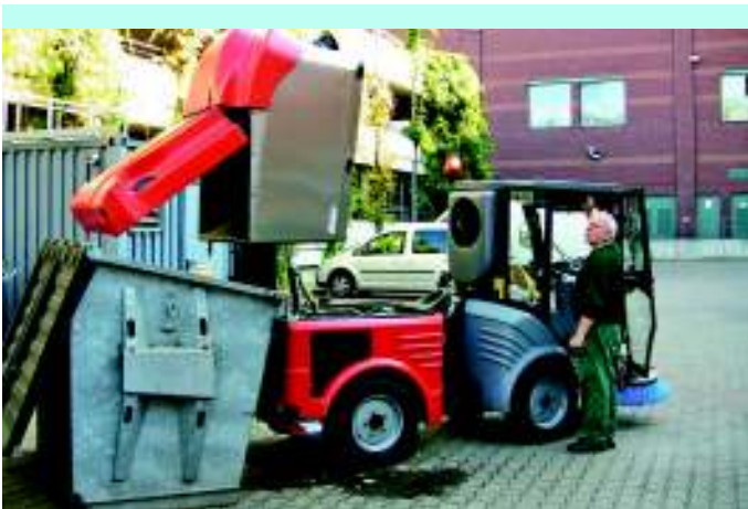
Hochentleerung der Kehrmaschine: Im Außenbereich werden alle erdennlichen Schmutzarten aufgenommen.
