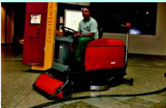
Scheuersaugmaschine mit Kehrvorsatz: Diese Lösung erspart einen Arbeitsgang.
